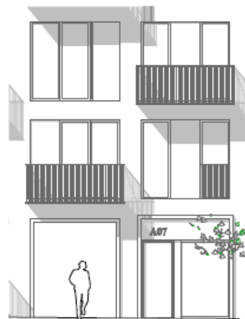
Facadeudsnit med port og opgang
